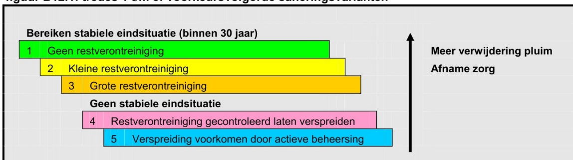
figuur B12.1: tredes 1 t/m 5: voorkeursvolgorde saneringsvarianten
