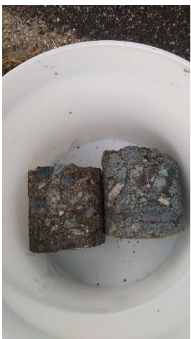
Foto 4: Slakken S4 fundatie (boringen 101 en 102)
