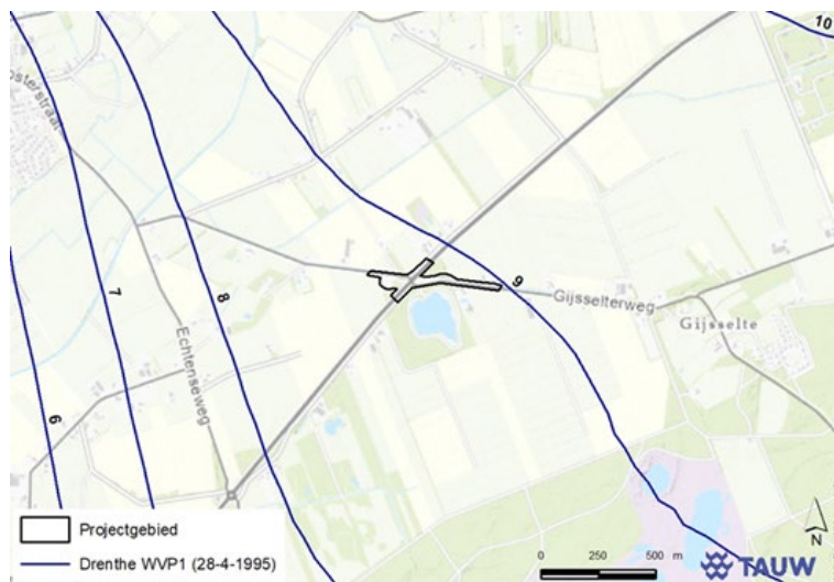
Figuur 3.7 Kaart met isohypsenlijnen en locatie tunnelbak
