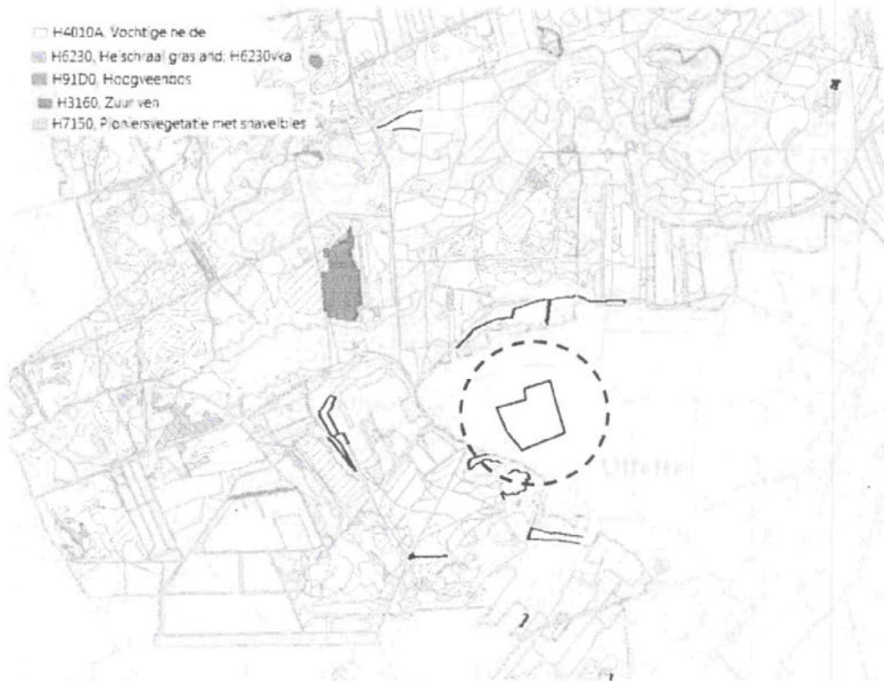
Figuur 3-2. Berekend invloedgebied drainage. Zwarte tippellijn= 5cm contour (ca. 300 m); blauwe stippellijn=2 cm contour (1.400 à 2.100 m)
