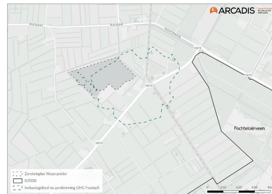
Figuur 3-6 Het maximale invloedsgebied bij de GHG na de zandwinning ten opzichte van de situatie voor de zandwinning.
