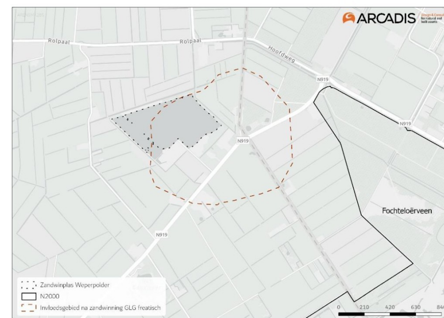
Figuur 3-7 Het maximale invloedsgebied bij de GLG na de zandwinning ten opzichte van de situatie voor de zandwinning.
