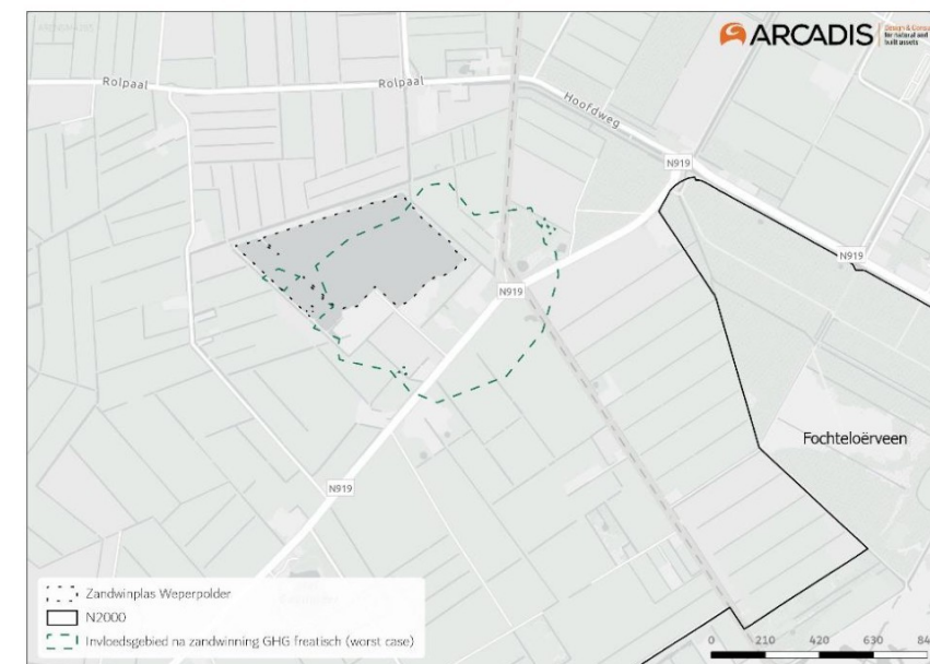
Figuur 3-10 Het maximale invloedsgebied bij de GHG na de zandwinning ten opzichte van de situatie voor de zandwinning (wanneer de Formatie van Peelo niet uit een kleilaag met hoge weerstand bestaat).
