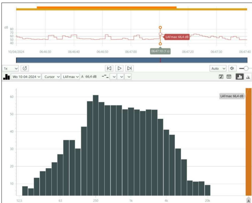
Screenshot uit "Enviro Noise Partner" met het spectrum ten tijde van de overschrijding bij het storten van metaal (oranje marker is "storten metaal")
