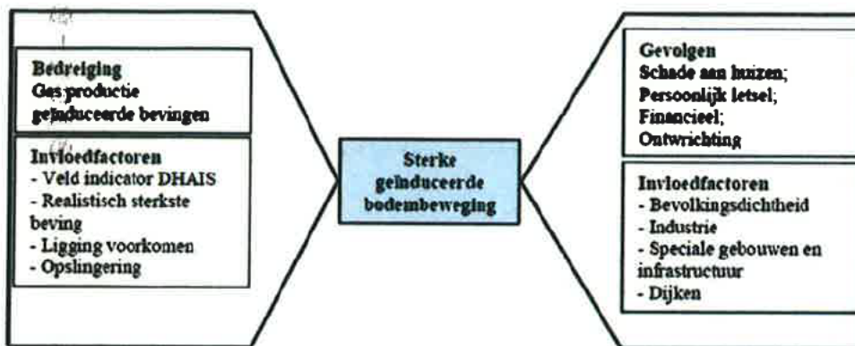
Figuur 1.2: Schematische weergave van de bedreigingen en gevolgen van geïnduceerde bevingen en de verschillende invloedfactoren die daarbij een rol spelen (SodM, 2016).
