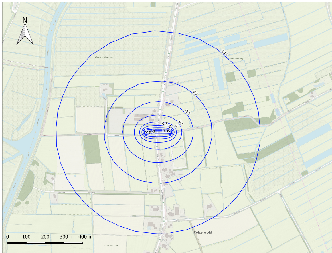
Figuur 1: Contourlijnen van het invloedsgebied van de bemaling.
