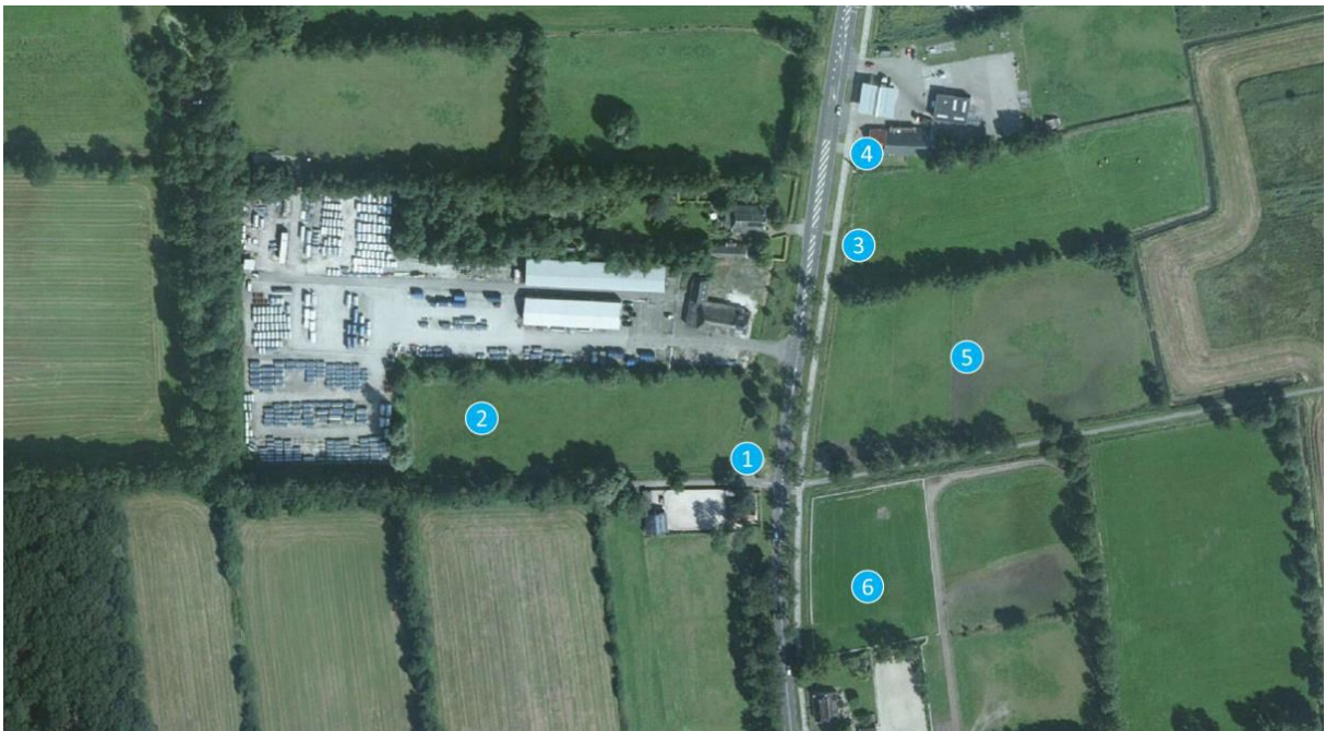
Afbeelding 1 - Afbeelding 5.1 Locaties van de peilbuizen voor monitoring
