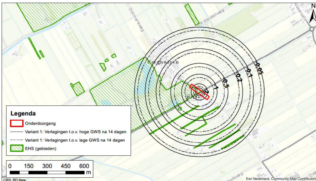
Figuur 4-2: Bemalingsvariant 1 - Berekende verlaging van de grondwaterstand na 14 dagen bemalen (invloedsgebied ca. 510 m)
