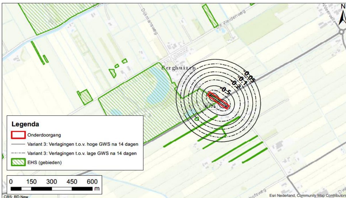
Figuur 4-6: Bemalingsvariant 3 - Berekende verlaging van de grondwaterstand na 14 dagen bemalen (invloedsgebied ca. 290 m)
