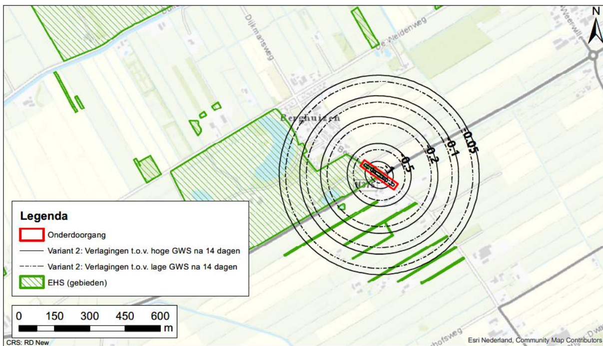
Figuur 4-4: Bemalingsvariant 2 - Berekende verlaging van de grondwaterstand na 14 dagen bemalen (invloedsgebied ca. 410 m)
