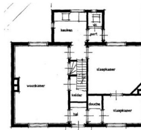
Plattegrond van de bestaande situatie in 1992 waarop te zien is dat de bedstedes weg zijn, een hoekschouw is toegevoegd en naast de hal een douchecel is gemaakt in de kleine slaapkamer
