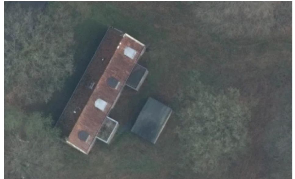
Bouwblok E-F bestaande uit een eenlaags rechthoekig volume met bij elke woning een aanbouw onder een plat dak en achter de woningen een schuur. Aan de kleur van de dakkapellen is te zien dat twee zijn voorzien van bitumen en twee van zink. Bron: PDOK
