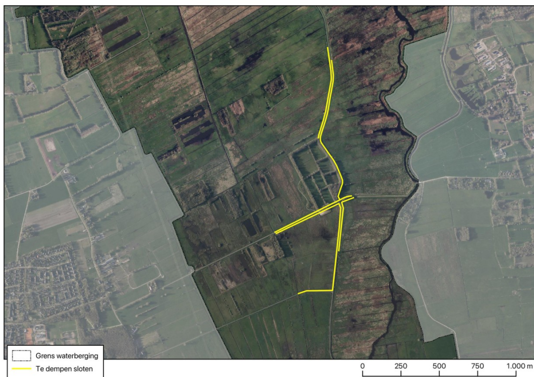
Afbeelding 27 Locatie van de te dempen bermsloten
