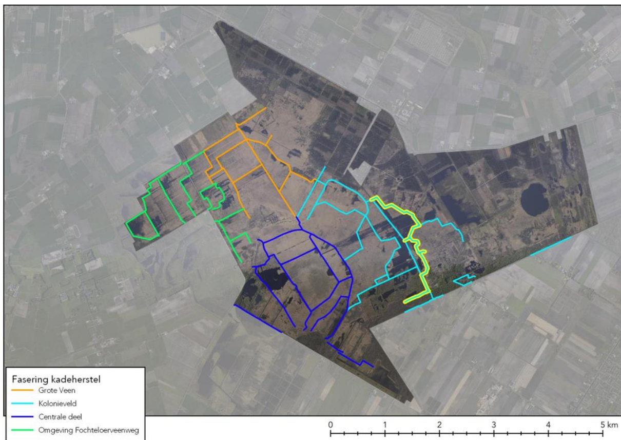
Afbeelding 5.1 De te herstellen kades binnen het Natura 2000-gebied Fochteloërveen. Fase 1 wordt uitgevoerd in deelgebied Grote Veen (gehele deelgebied) en kolonieveld (deels, 3,5 km binnen de gele contour).
