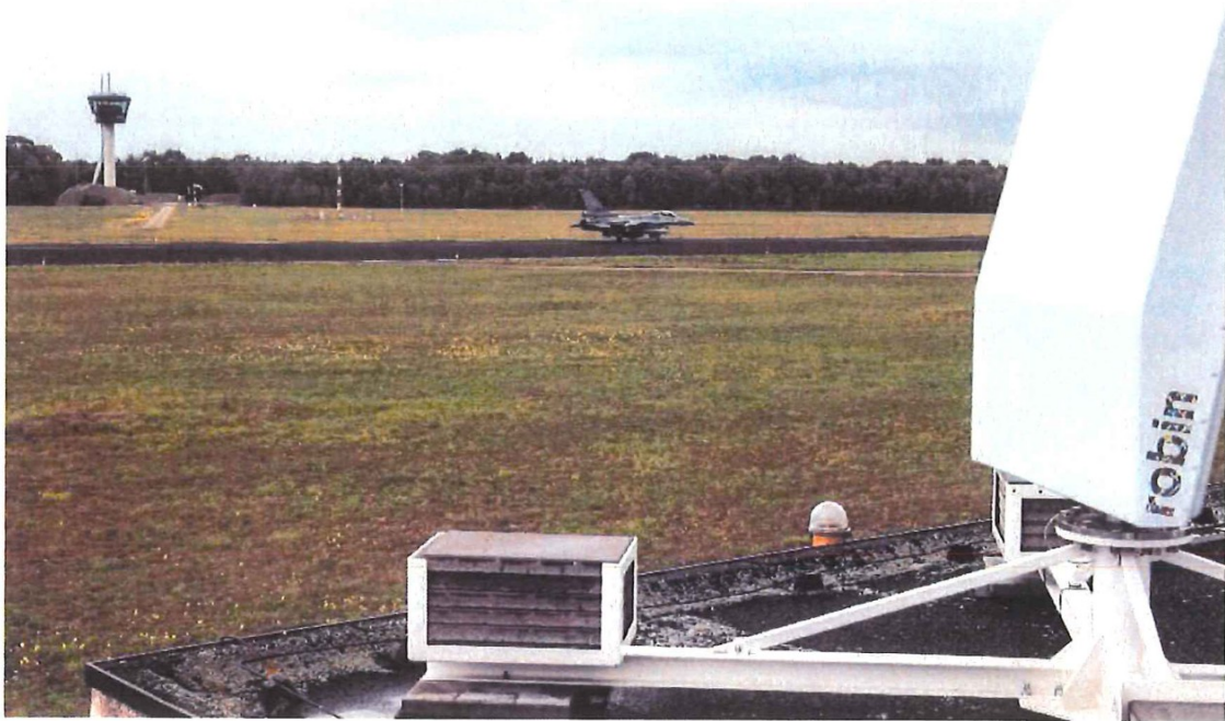
Figuur 1 Op alle militaire vliegvelden staan vogelradars, die het luchtruim tot een afstand van ca 6 km dag en nacht in de gaten houden. Wanneer er teveel vogels in de lucht vliegen of de startbaan oversteken worden de vliegers gewaarschuwd en gelden beperkingen voor het trainen.
