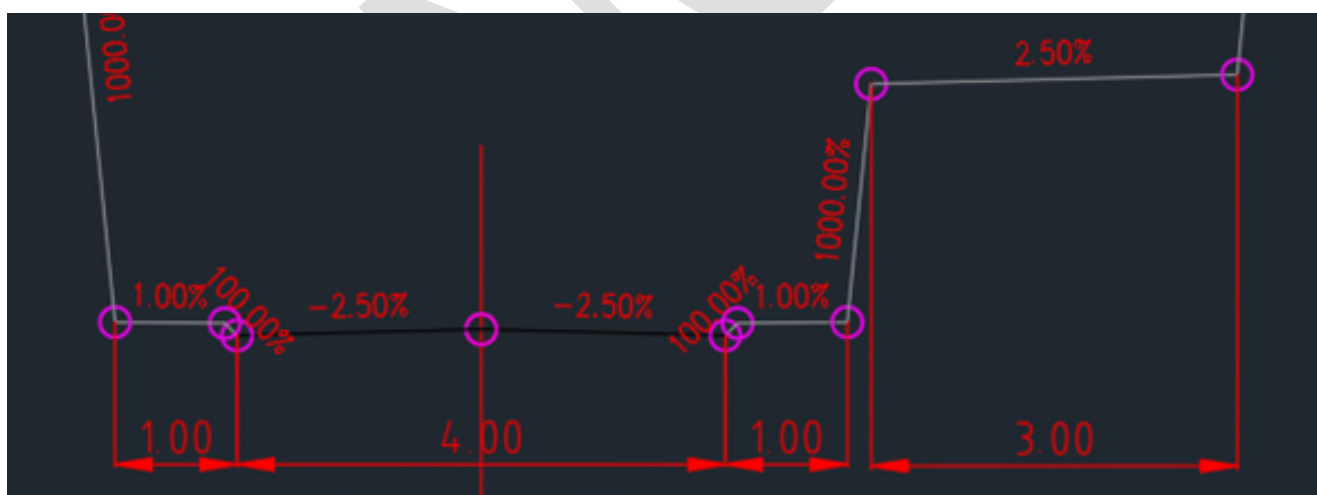
Figuur 2.3: Schets afmetingen doorsnede onderdoorgang
