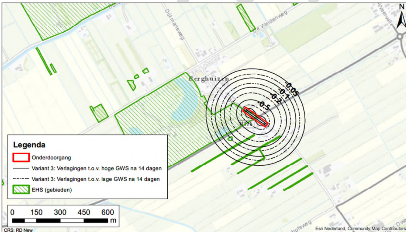
Figuur 4.6: Variant 3 - Berekende verlaging van de grondwaterstand na 14 dagen bemalen (invloedsgebied ca. 290 m)
