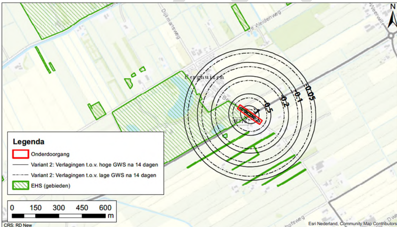
Figuur 4.4: Variant 2 - Berekende verlaging van de grondwaterstand na 14 dagen bemalen (invloedsgebied ca. 410 m)
