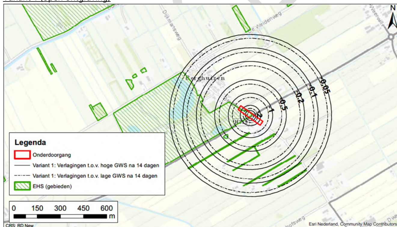
Figuur 4.2: Variant 1 - Berekende verlaging van de grondwaterstand na 14 dagen bemalen (invloedsgebied ca. 510 m)
