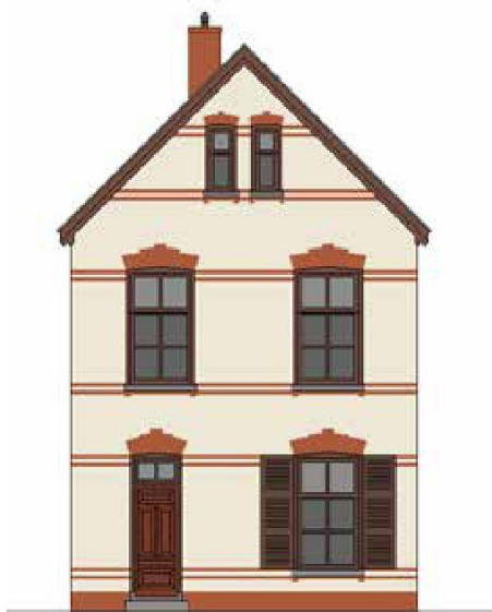
Reconstructie kleurconcept van het eenvoudige smalle en brede villatype. Kastanjebruin is de hoofdkleur. De voordeur is afgewerkt met houtimitatie. In deze reconstructie is uitgegaan van mahonie-imitatie, aansluitend bij het kastanjebruin en de rode klinkers van de gemetselde sierbanden, hanekammen, plinten en schoorstenen.
