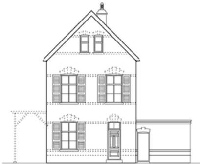
Zijgevel met entree. Zijgevel met entree, aanbouw met bijkeuken, aan de achterzijde, pergola aan openbare weg.
