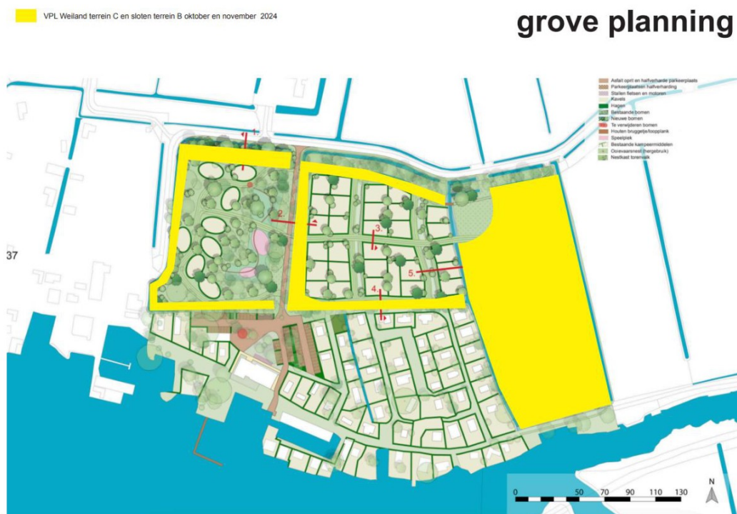
Figuur 5 Fase 1 oktober en november 2024 waarin slootoevers worden verbeterd, de pool wordt gegraven en bomen en struiken worden aangeplant
